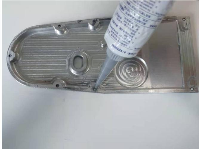
4、在手臂本體側的连接面處若有沉頭螺絲，則需用密封膠將其完全填充防止水從此處滲透進手臂內部，如下圖所示：
